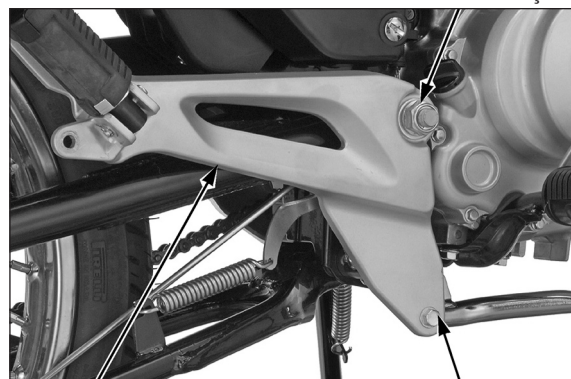
SUPPORTO DO PEDAL DE APOIO DIREITO DO PASSAGEIRO PINO DE CONEXÃO
