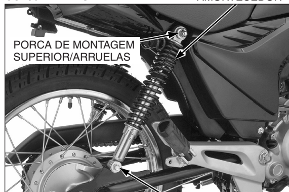
PARAFUSO DE MONTAGEM INFERIOR/ARRUELA
