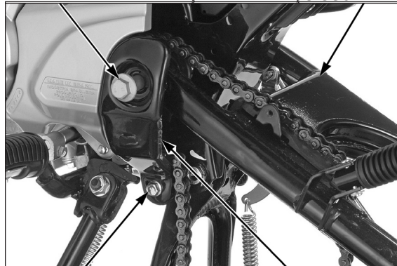
PARAFUSO DE MONTAGEM PLACA LATERAL
