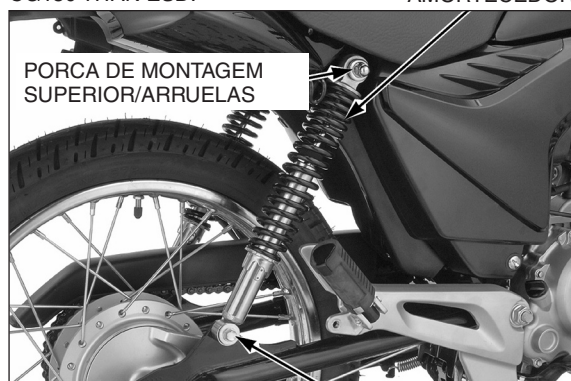
PARAFUSO DE MONTAGEM INFERIOR/ARRUELA
