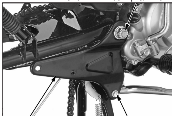
SUPPORTO DO SILENCIOSO PARAFUSO DE MONTAGEM
