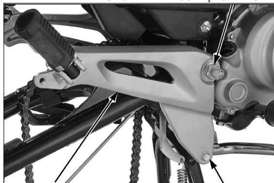
SUPPORTO DO PEDAL DE APOIO DIREITO DO PASSAGEIRO PARAFUSO DE MONTAGEM PARAFUSO DA ARTICULAÇÃO BRAÇO OSCILANTE
